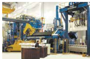
Экструзионно-трубный пресс 55 MN
