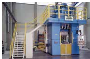
Гидравлический порошковый пресс типа HPM 1200 E3 с ЧПУ
