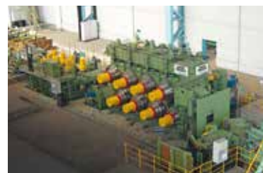
Рельсовая горизонтально-вертикальная правильная установка
