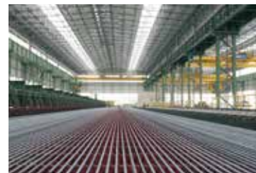
Холодильник с высокоскоростной системой выхода HSD®
