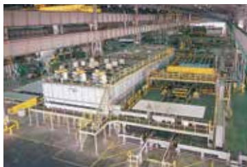
Установка непрерывной гомогенизации с транспортной механизацией
