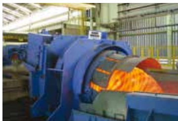
Виткоукладчик с охлаждающим транспортом (LCC®)
