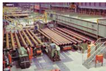
Гидроиспытательный пресс с муфтонаверточным станком
