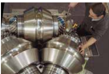
Настройка валков на редукционно-растяжном стане (SRW)
