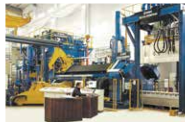
55 MN 押し出し成形機及びチューブプレス機
