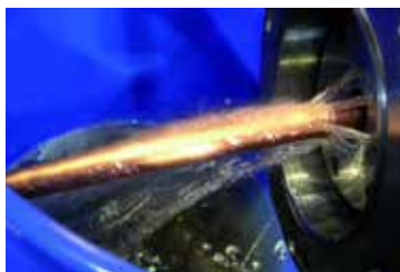
銅チューブ 注油システム
