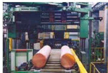
用于生产挤压坯的立式全连铸机
