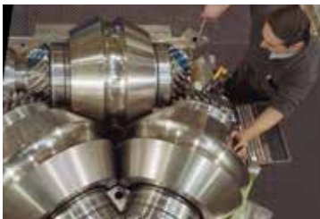
张力减径机的轧辊调节
