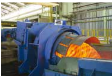
吐丝机及散卷冷却段 (LCC®)
