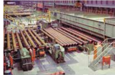
水压试验机与接箍拧接机
