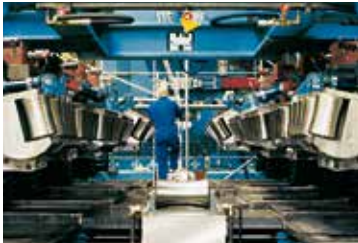
24" 直边线性成型生产线的安装
