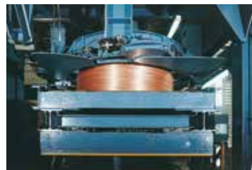
用于铜线杆缠绕的配有盘卷成型室的吐丝头
