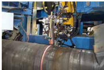
埋弧焊接生产线
