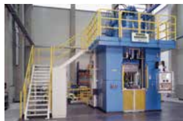
HPM 1200 E3 型 CNC 数控液压粉末成型压机
