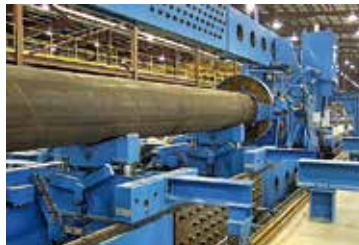
无损探伤检测
