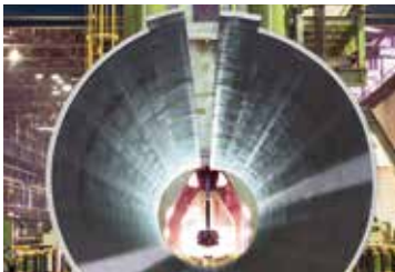
大口径直缝焊管 JCO® 钢管成形压机
