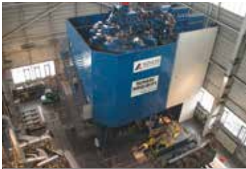
SPKA 22400 离合器操作的螺杆压机
