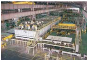
带有输送装置连续均匀化炉
